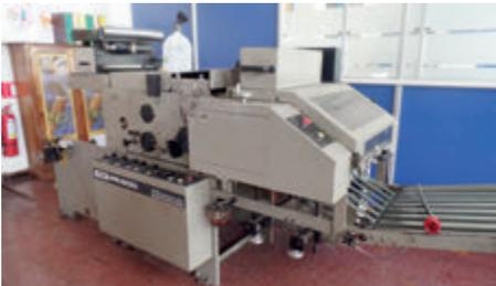
**Ryobi PR600:** Prensa offset monocolor que imprime formulario continuo (en bobinas). Posee unidad de plegado.
