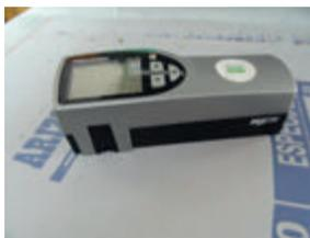
Instrumento que permite medir la tira de control de planchas offset
